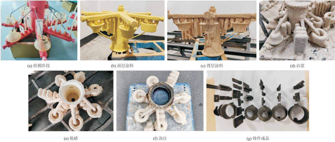
图 2 TiAl 及 Ti 2 AlNb 合金特征结构元件精密铸造
